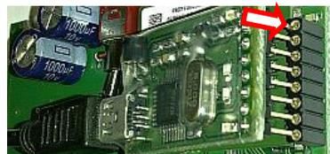
2. Desmonte el panel frontal del equipo e inserte el conector del módulo de programación en el equipo (ver imagen). El LED rojo del módulo de programación lucirá parpadeando al igual que el LED amarillo del equipo GDI.
